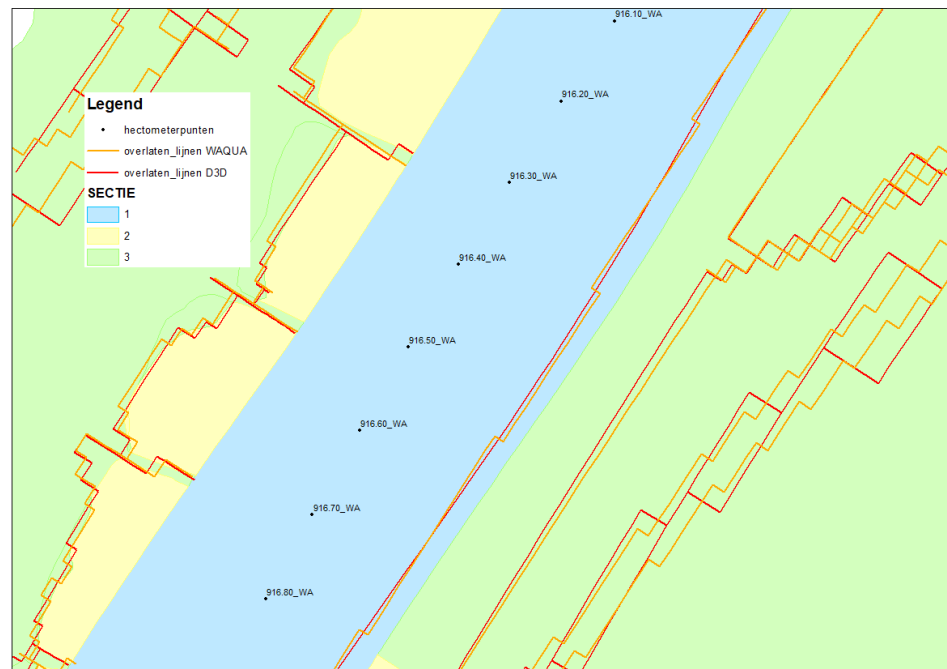
Figuur 12 De langsdam geprojecteerd op het WAQUA en Delft3D rooster bij km 916,5.
