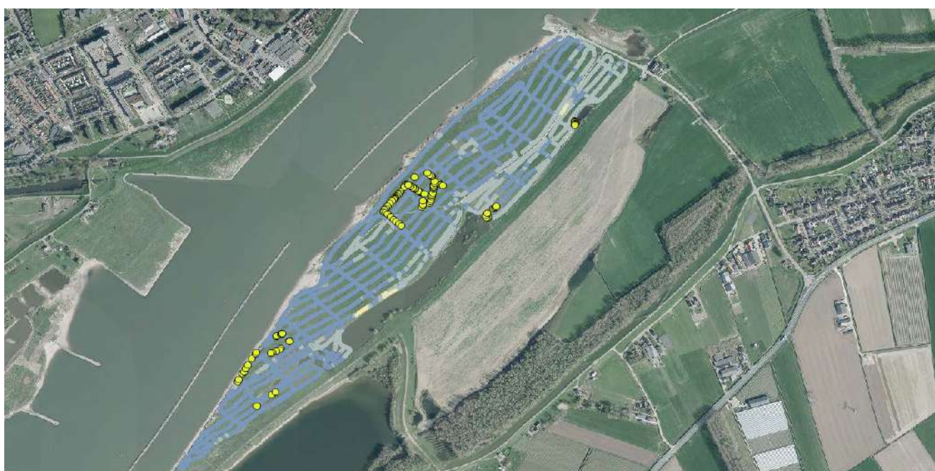
Figuur 27: Het resultaat van het grondradaronderzoek in Gebied 5. Gele cirkels geven de locaties aan waar de toplaag zandig is.
