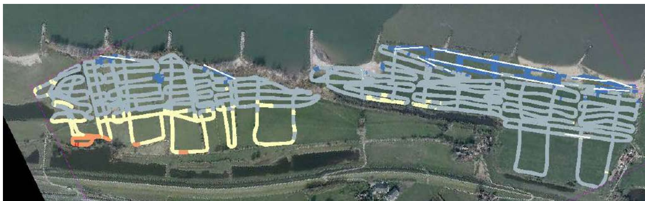
Figuur 23: Het resultaat van het grondradaronderzoek in Gebied 2. Witte lijnen geven de locaties aan waar de toplaag zandig is.
