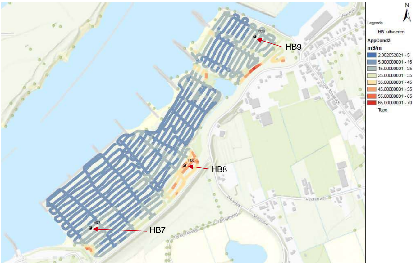
Figuur 15: Voorbeeld contourbeeld overzicht gebied 3 met EM data tot een diepte van 6.7 m-mv
