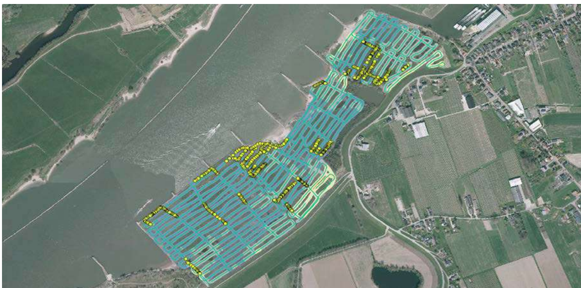
Figuur 25: Het resultaat van het grondradaronderzoek in Gebied 3. Gele cirkels geven de locaties aan waar de toplaag zandig is.
