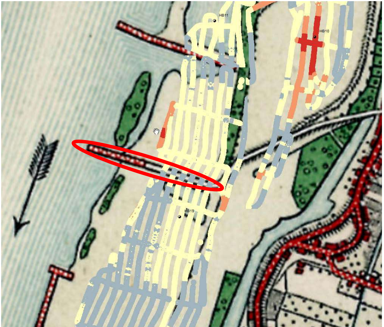
Figuur 17: Voorbeeld contourbeeld van gebied 4 met EM data tot een diepte van 4,2 m-mv met als ondergrond historische topografische data uit 1950
