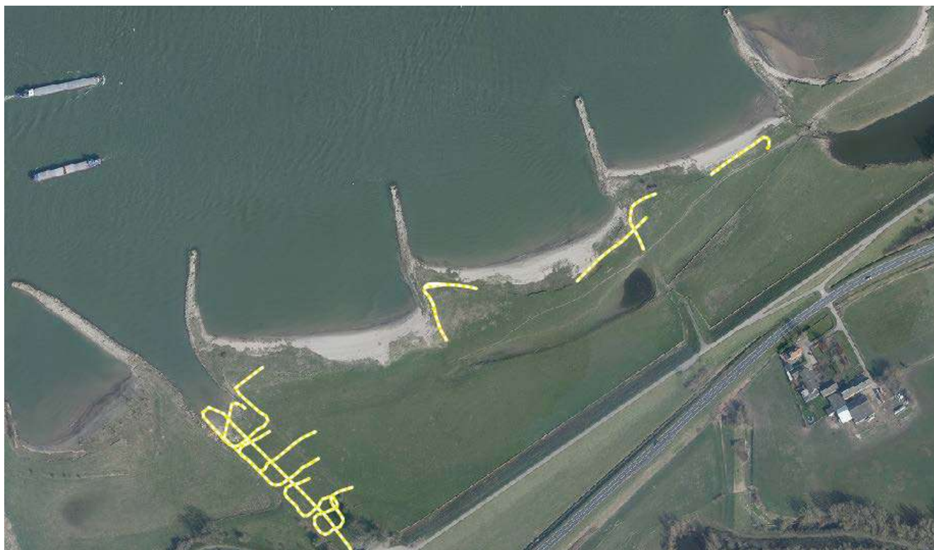
Figuur 22: Het resultaat van het grondradaronderzoek in Gebied 1. Gele lijnen geven de locaties aan waar de toplaag zandig is.
