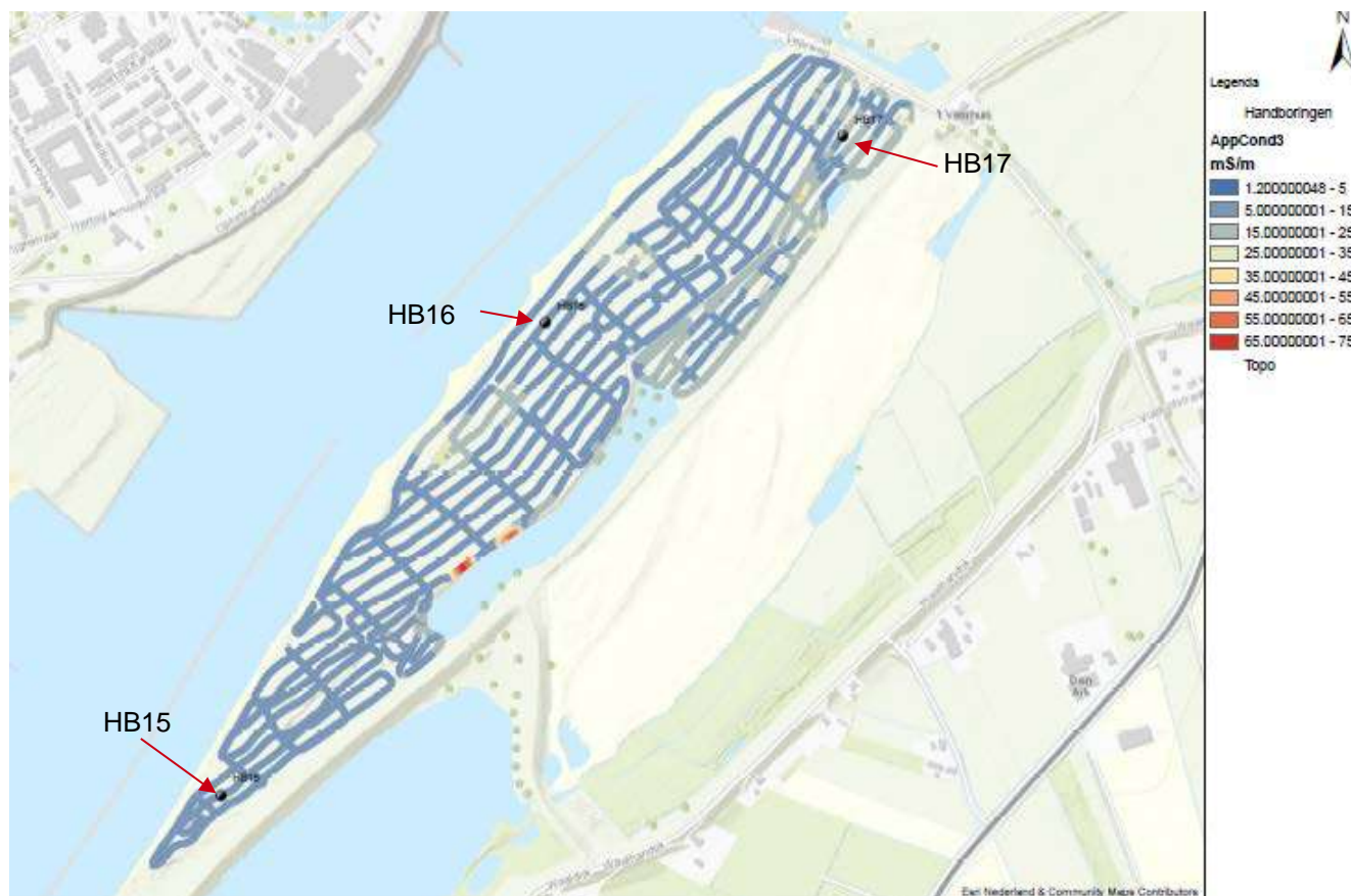
Figuur 18: Voorbeeld contourbeeld overzicht gebied 5 met EM data tot een diepte van 6.7 m-mv
