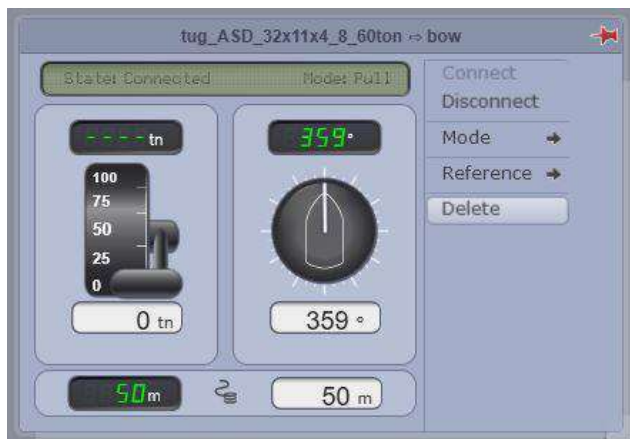
Figuur 2-9: Bedieningsvenster voor instructeur-gecontroleerde sleepboten
